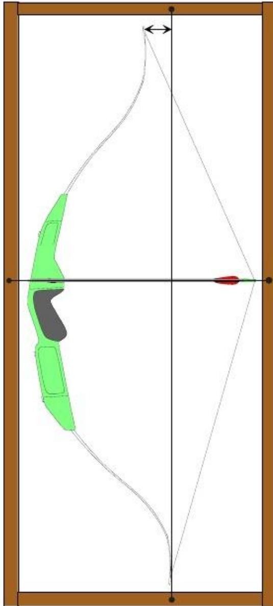
Le réglage du tiller consiste à optimiser la synchronisation des branches de l'arc. Il a peu d'influence sur le groupement des flèches pour peu que la hauteur d'encochage soit bien réglée. C'est en revanche un réglage qui permet d'améliorer la stabilité de la visée dans le sens vertical.
