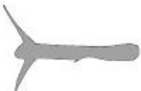
Type E : Cette déchirure indique un tube trop souple ou un problème de sortie.
